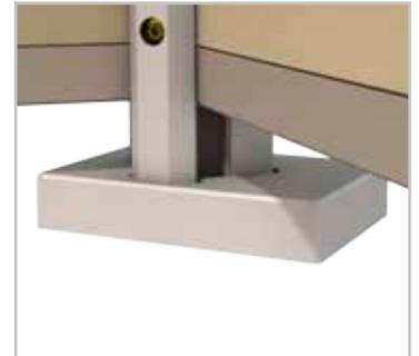
Vor Montage der Deckleiste die Öffnung der Pfostenschuhabdeckung entlang der perforierten Kante vorsichtig vergrößern. Kante ggf. nachfeilen.
