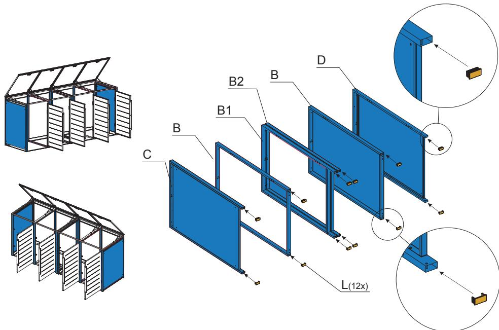
2. Schrauben Sie nun die Magnethalter (**I1**) an den Seitenwänden (**B**, **B2** und **C**) an und sichern Sie sie mit den Schrauben M4×10mm (**R**).
